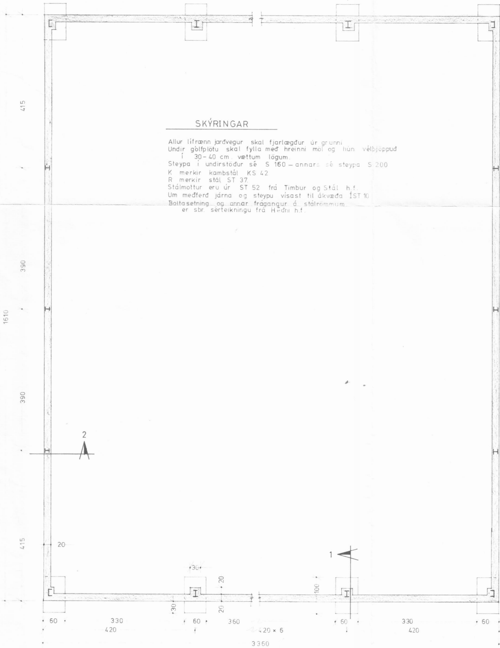
GRUNNMYND UNDIRSTAÐNA MKV. 1:50
